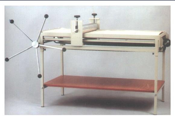
Das Gestell besteht aus massivem, lackiertem Stahlrohr. Die Walze besteht aus einem verzinkten Stahlzylinder. Die Plattenstärke lässt sich stufenlos von 1 - 70 mm (genau ablesbare Maßskala) durch verstellen von zwei Handrädern einstellen. Der Ton wird zwischen das mitgelieferte Grobleinen gelegt. Der Schlitten der Stahlwalze wird durch ein großes Handrad angetrieben.
